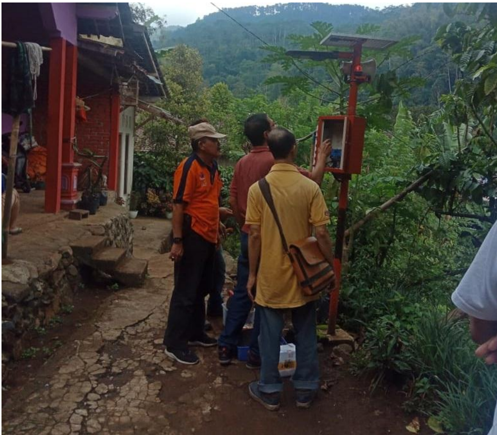
Penggantian software telemetri EWS longsor didusun batur desa Citrosono kec. Grabag
